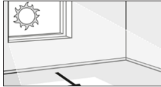
Leg bij voorkeur het PVC met het licht mee
